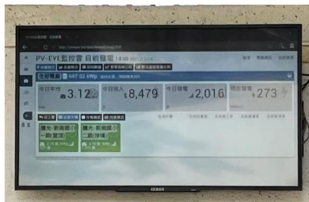
圖 2-1、校內即時發電效益監控設備示意圖
