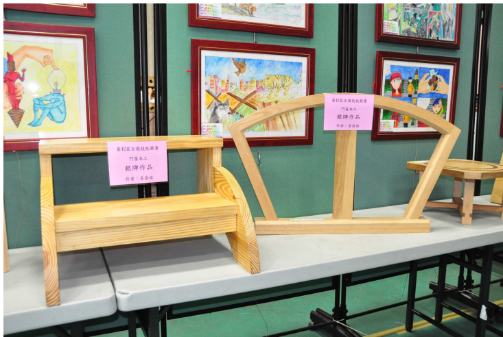
主題：樓梯椅及造型窗 作者：國立員林崇實高工 家具設計科 房俞佑 (第 42 屆全國技能競賽門窗木工銀牌作品)
